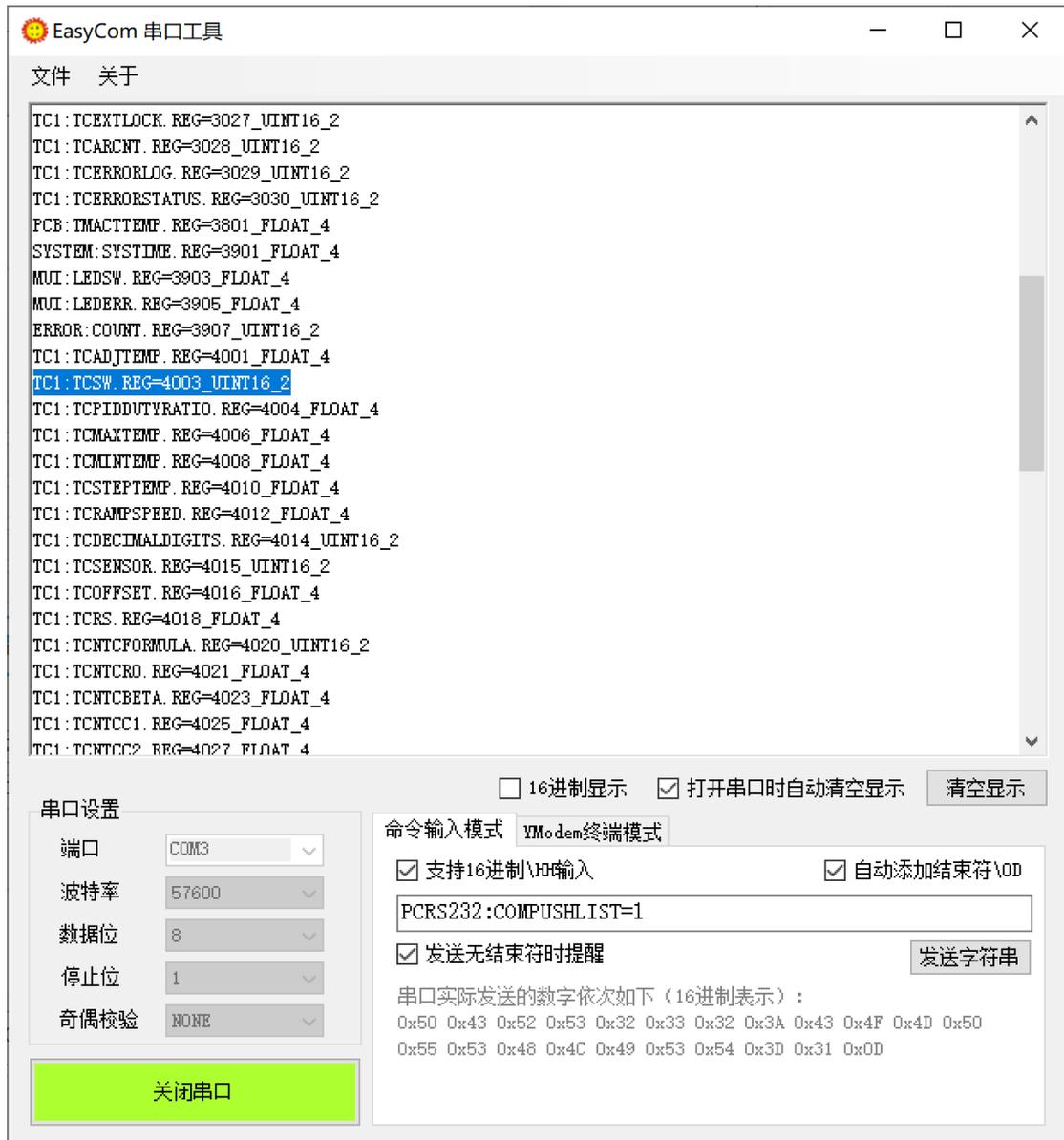
从上图得知，TCSW 和 TCPIDDUTYRATIO 的索引分别是 4003 和 4004；被推送的 4 个参数的索引分别通过参数 Index 1、Index 2、Index 3、Index 4 设置；如下图所示。
