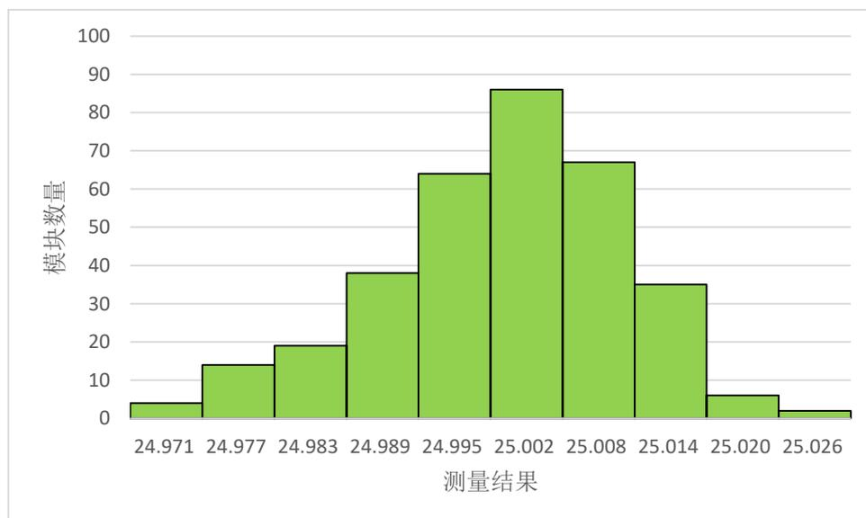
336 个模块测量 0.01% 1k 电阻的统计结果:
