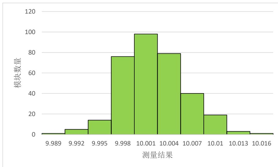
336 个模块测量 0.01% 10k 电阻的统计结果, 换算成 3950 10k 热敏电阻的温度误差:
