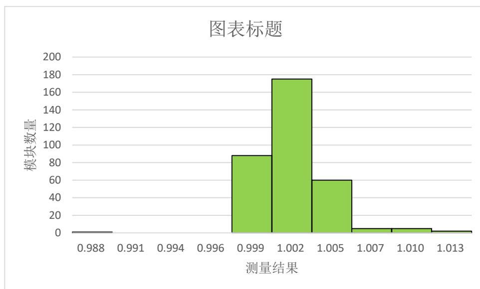
336 个模块测量 0.01% 100k 电阻的统计结果:
