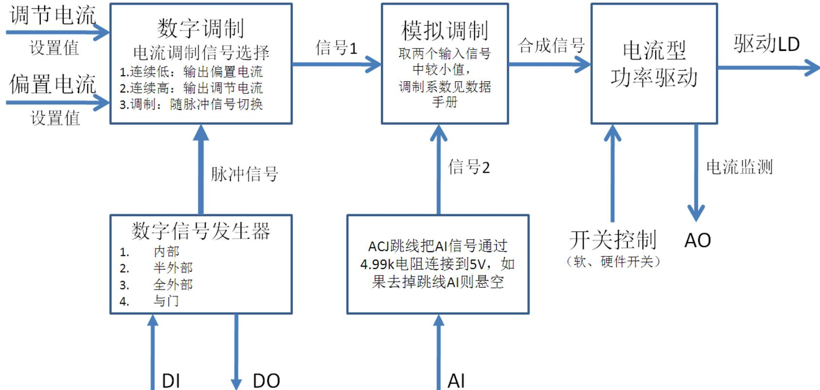
电流具有数字调制和模拟调制两种调制方式，可单独使用，也可以同时使用。数字调制是使用信号发生器输出的脉冲信号对电流进行调制，在“调节电流”和“偏置电流”之间快速切换，需要设置参数“电流调制信号”为“调制”；模拟调制无需设置，模拟调制接口 AI 的输入信号将直接调制电流信号。
